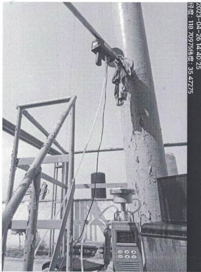
2023.04.26 精制车间废气排气筒出口采样图
